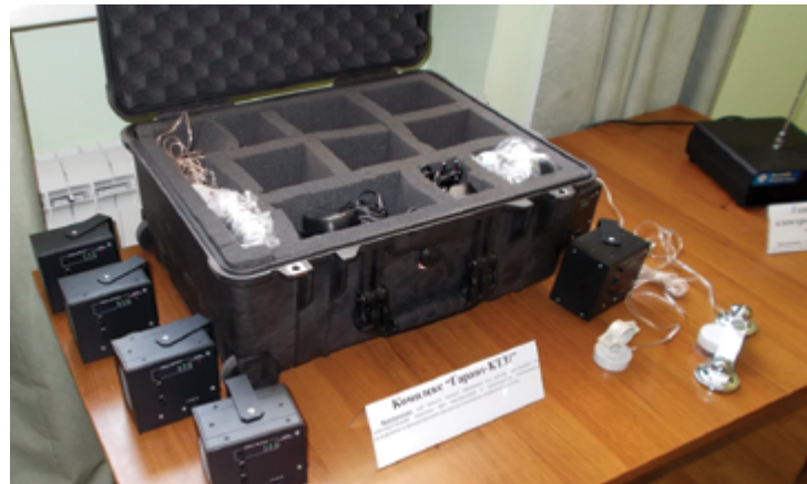
Автономный комплекс, содержащий генератор виброшума с модулями блокировки утечки звуковой информации через трубы системы отопления и через оконное стекло, а также генераторы звукового шумления в вентиляционных шахтах и других возможных каналах утечки
